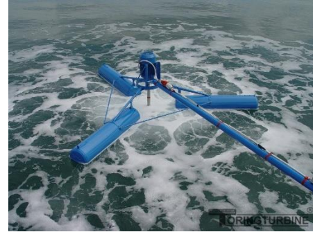
รูปที่ 4 เครื่องเติมอากาศใต้น้ำแบบแนวตั้ง [6]
